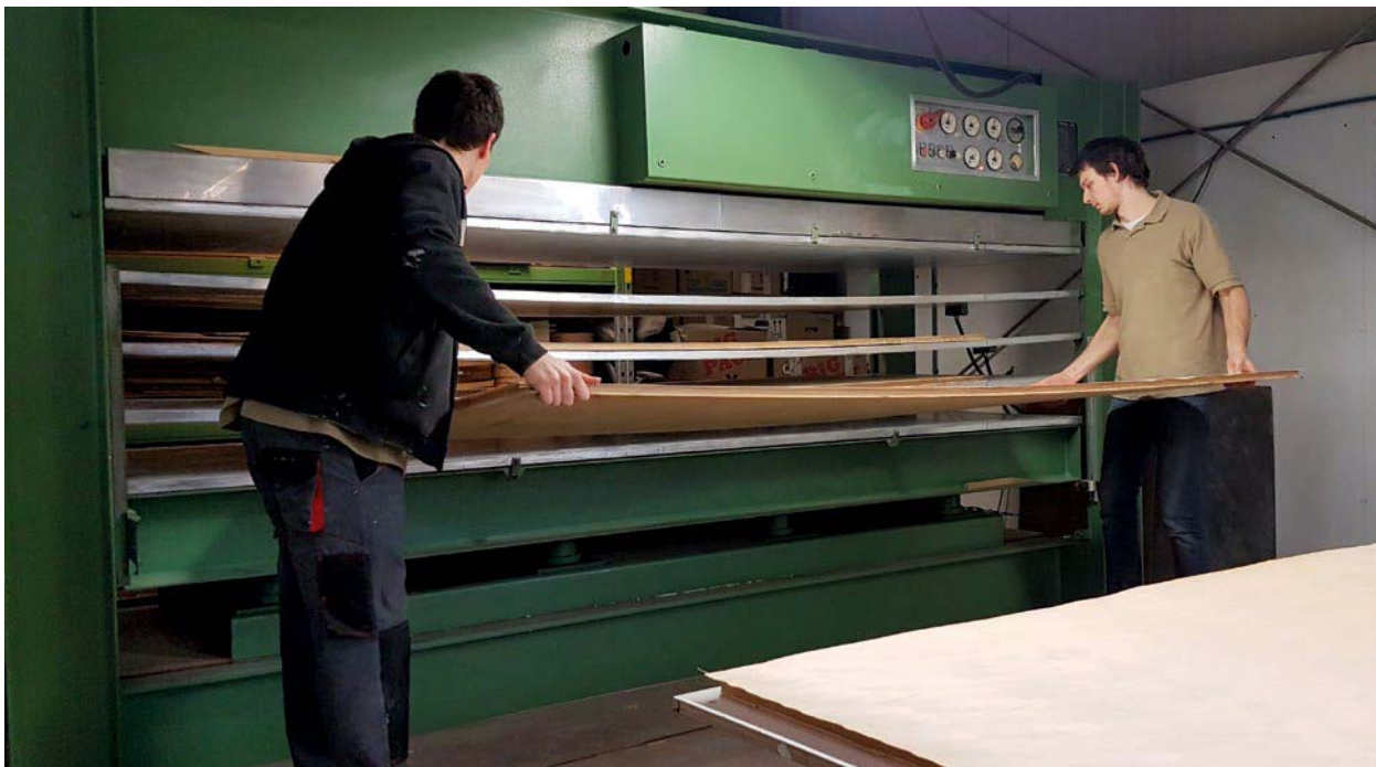
Die mehrlagige Sperrholzplatte wird aufwendig verpresst.
